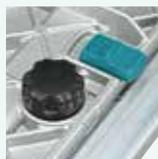
Se puede graduar la dureza del deslizamiento sobre la guía y sujetar la máquina a esta, para evitar caídas cuando se corta a 45°.
