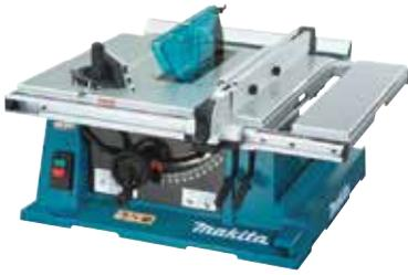
Equipo básico: llave allen, discos HM 260 mm, guía paralela, 2 llaves fijas, guía con inglete y stick de empuje.
