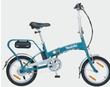
“Potencia Inteligente” en la que el motor nos aporta una fuerza proporcional a la energía con la que pedaleamos.
